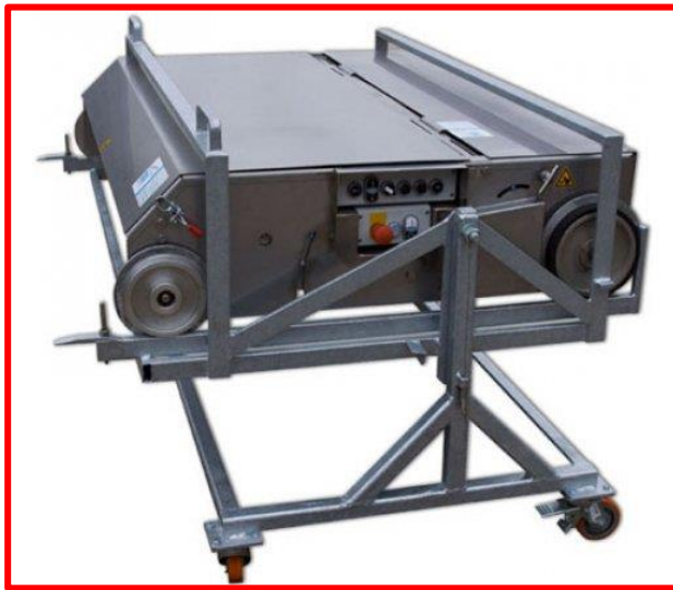
Kompost tiftikleme ve düzeltme makinası
