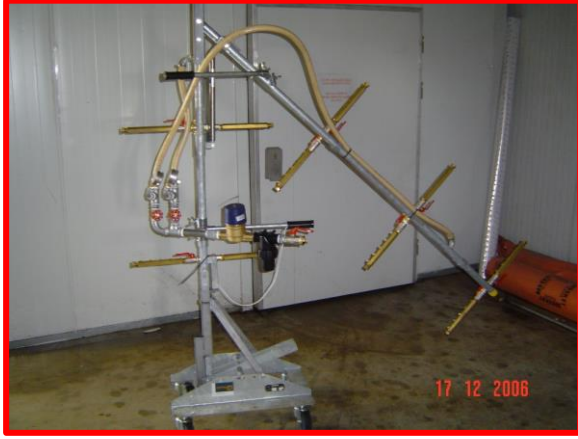
Sulama ağacı ve üretim odalarında kullanımı
