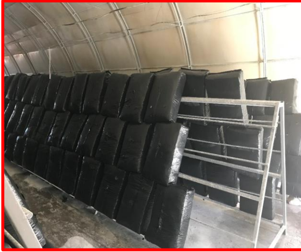
Diğerkompost taşıyıcı sistem (eşek sistemi)
