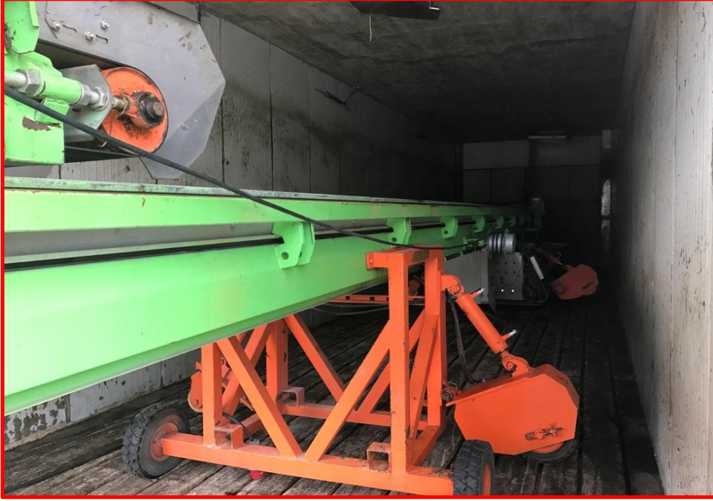
Kompostun pastörizasyon tüneline doldurulumu
