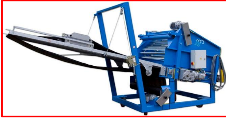
Örtü toprağı serim makinası
